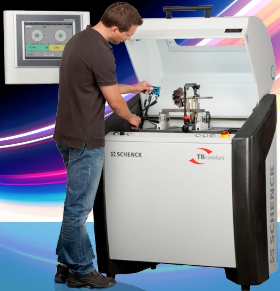
Mit der **TBcomfort** schaffen Sie die Basis für eine hochwertige Reparatur: Sie beseitigen im ersten Schritt die Urunwucht an den Komponenten und der montierten Läufergruppe. Damit schaffen Sie die Voraussetzung für das spätere hochoptimierte Auswuchten. Dabei erleichtern Ihnen die einfache und logische Bedienung der **TBcomfort**, die ergonomische Gestaltung des Gesamtsystems sowie die hohe Präzision die Arbeit. Zum Beispiel mit der
