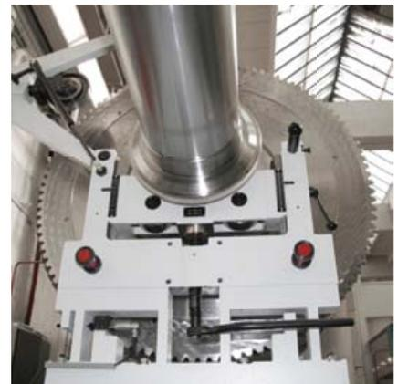
**HM-Lagerständer: Sehr schmale und stabile Lagerständer garantieren Gesamtsteifigkeit, Linearität und sehr geringe Dämpfung. Einsatz des Schenck-Kraftmessprinzips, wobei der mittlere Teil des Lagerständers als robustes Dynamometer ausgeführt ist. Die Messwertnehmer liegen außerhalb des Kraftflusses und sind somit unempfindlich gegen Stöße.**
