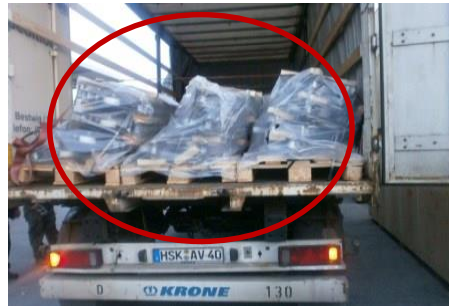
Falsche Ladungssicherung, nicht genügend Spanngurte
