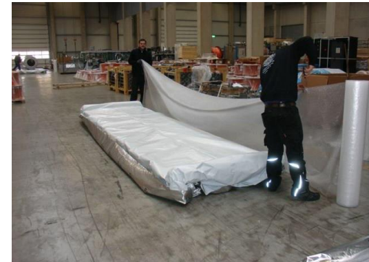
Holzboden mit Alufolie / Luftpolsterfolie
