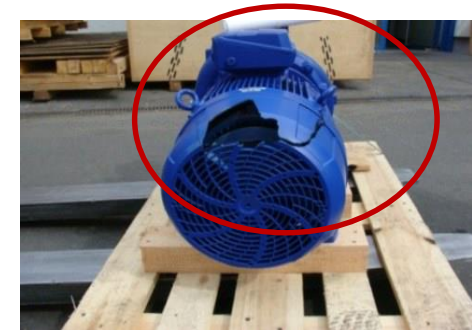
Beschädigung durch falsche Ladungssicherung / fehlende Umverpackung
