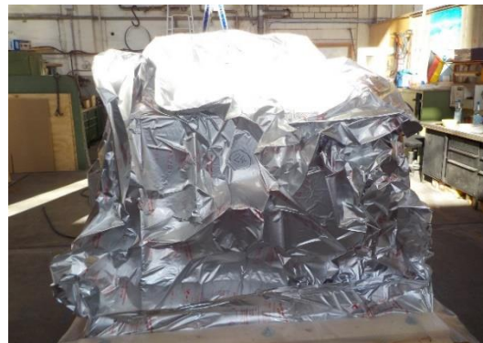
Abdeckung mit Aluminiumverbundfolie
