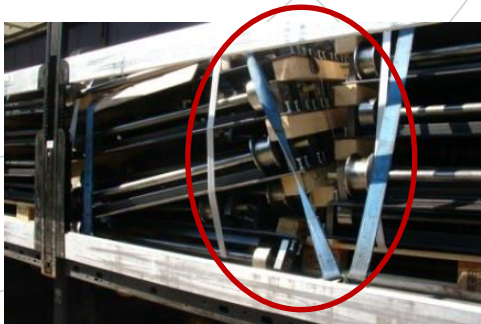
Falsche Ladungssicherung, Spanngurte nicht richtig gesetzt
