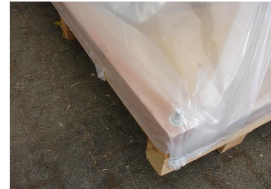
Zusätzliche PE Folie über den Transportboden
