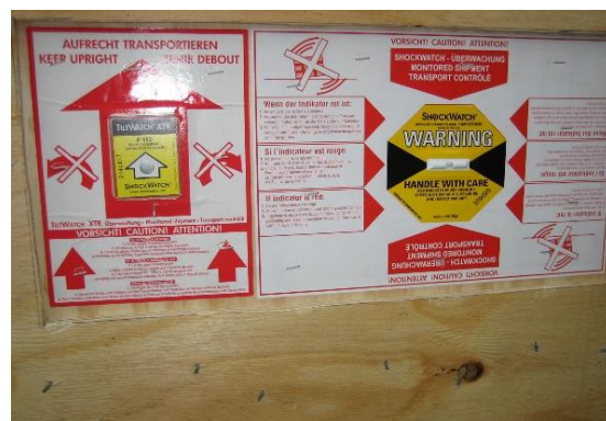
Anbringung von Stoßindikatoren
